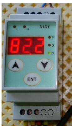
Служи за отброяване на детайли или събития, измервайки зададен брой електрически импулси, формирани от сензора, след което изходът се включва за определено време, което се програмира.
