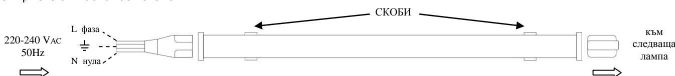
**Символ за заземяване.** Проводникът е оцветен в жълто. Разместяването на проводници L и N няма да се отрази на работата на светилното тяло. **Внимание!** не разместявайте L и N проводниците със жълтия „заземяващ“ проводник.
